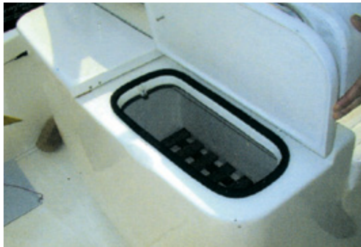
Frigorifero a pozzetto o vasca del vivo. cockpit refrigerator or bait/live well.
