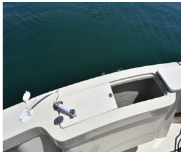
vasca del pescato o gavone ripostiglio. built-in fish box.
