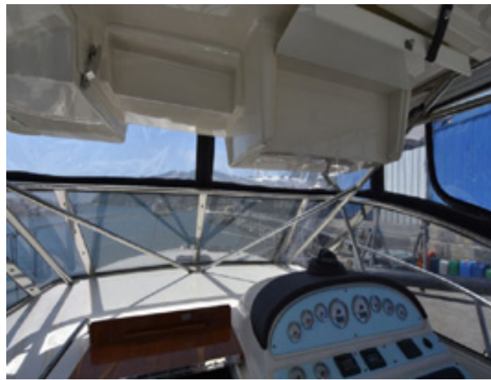
gli strumenti e il VHF sono protetti in un vano chiudibile sopra la timoniera. above the helm control station is located a closing instruments box.
