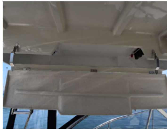
portacanne chiudibile ricavato sotto l'hard top. rod holders in moulded locker under the hard top.
